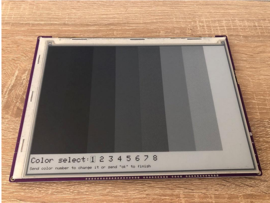
Slika 5.2. Primjer nekalibriranog ekrana s vidljivim šumom i prevelikom odstupanjima
