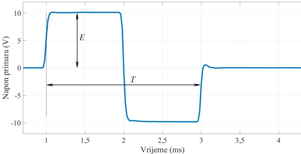
**Slika 5.2.** Prikaz naponskog testnog signala narinutog na primar [1].
