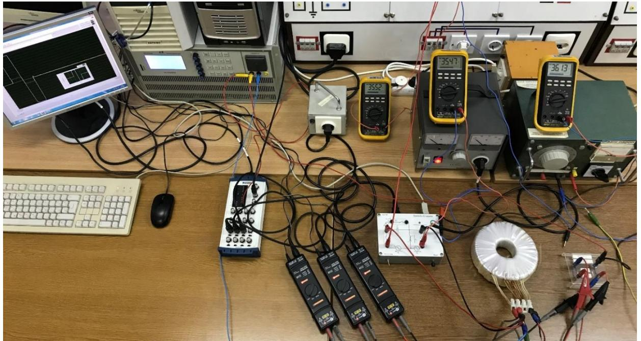
**Slika 5.1.** Prikaz laboratorijske postave za mjerjenje magnetskog toka [1].
