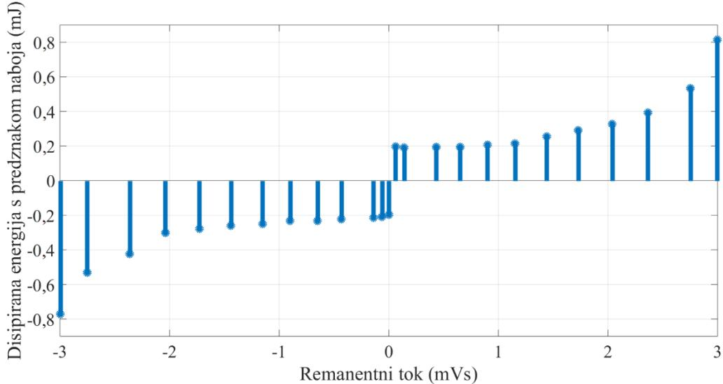
**5.2.** Prikaz ovisnosti disipirane energije o magnetskom toku [1].
