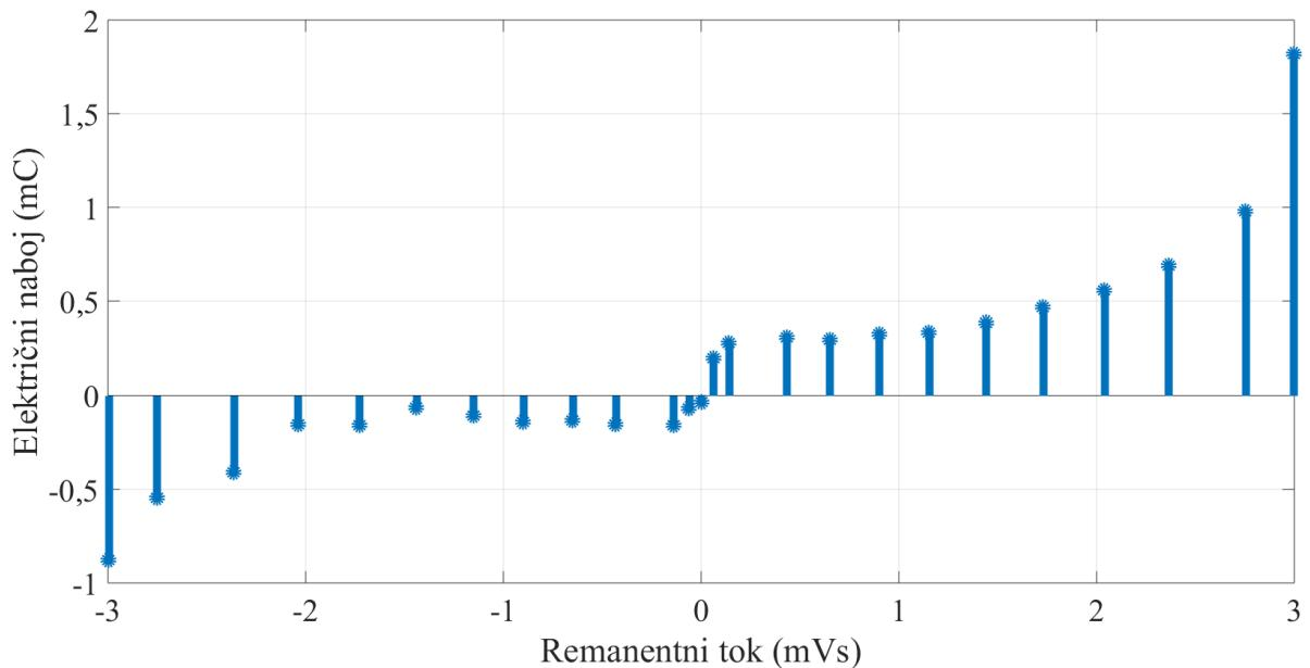
**Slika 5.4.** Ovisnost električnog naboja o remanentnom magnetskom toku [1].
