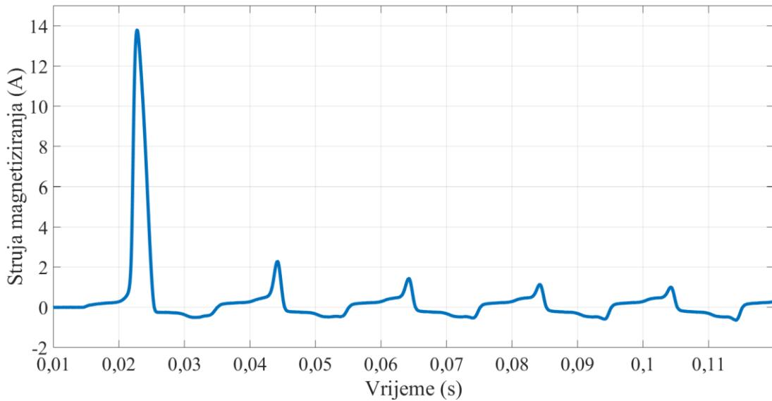
**Slika 2.2.** Udarna struja magnetiziranja [1].
