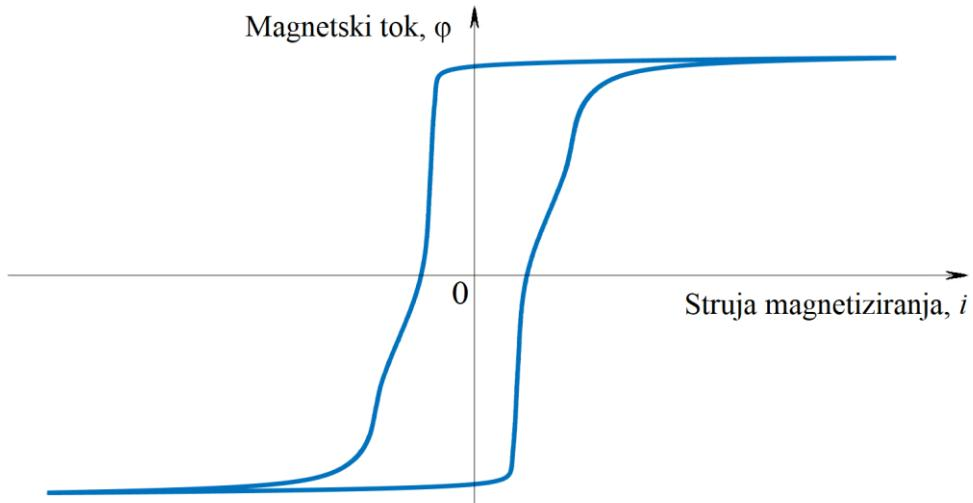
**Slika 2.1.** Karakteristika ovisnosti magnetskog toka o struji magnetiziranja [1].
