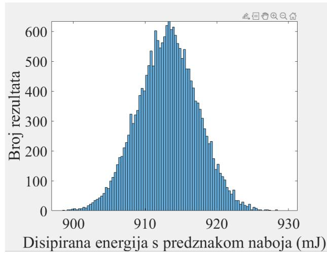
**Slika 6.1.** Prikaz razdiobe parametra  $W_Q$  za nesigurnost od 2 % pri naponu sekundara  $U_2 = 21$  V (+).
