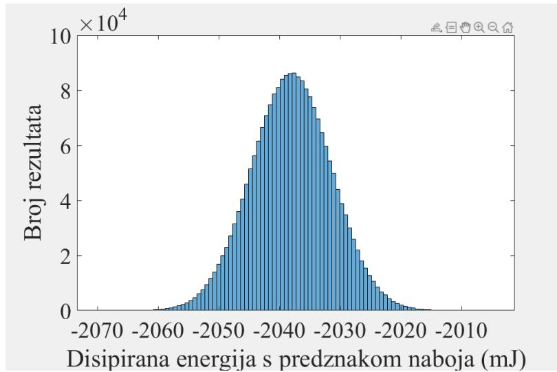
**Slika 6.2.** Prikaz razdiobe parametra  $W_Q$  za nesigurnost od 2 % pri naponu sekundara  $U_2 = 36$  (-) V.
