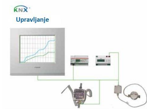
Slika 2.7. : Shematski prikaz povezivanja s KNX Metering pristupnikom [24]
