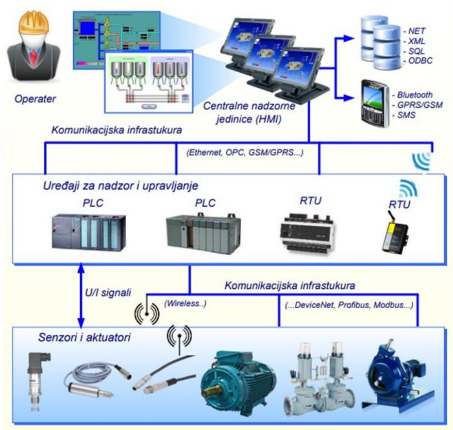
Slika 2.1. Kompletna infrastruktura sustava za nadzor i upravljanje [6]
