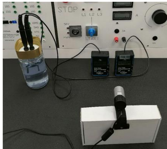
Slika 9.2 Prikazan je mjerni sklop kojeg čine termometar s otpornim temperaturnim senzorom, posuda s vodom i kamera
