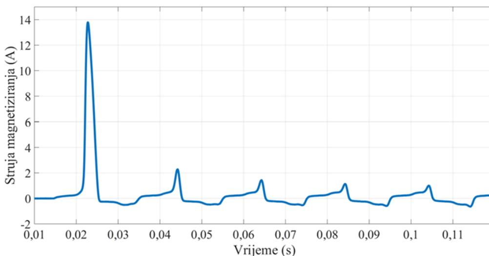
**Slika 2.3.** Valni oblik udarne struje magnetiziranja [1]
