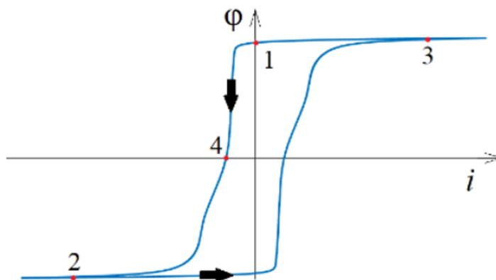
**Slika 3.7.** Postupak demagnetiziranja korištenjem CVVF metode [4]
