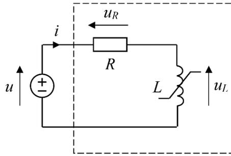
**Slika 3.2.** Model neopterećenog transformatora spojenog na izmjenični izvor
