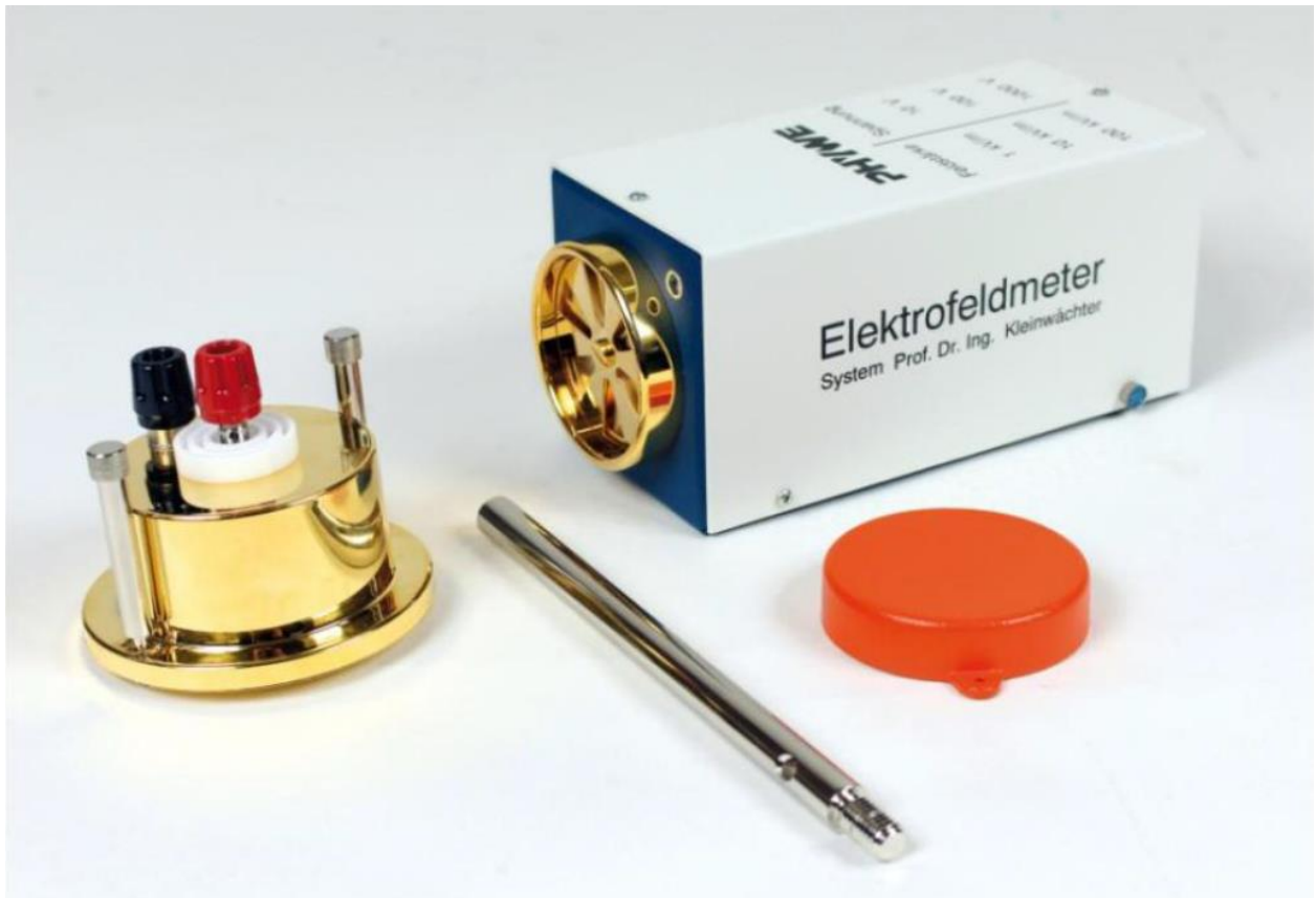
Slika 3.2. Mjerač električnog polja EFM 11500-20 proizvođača Phywe [10]
