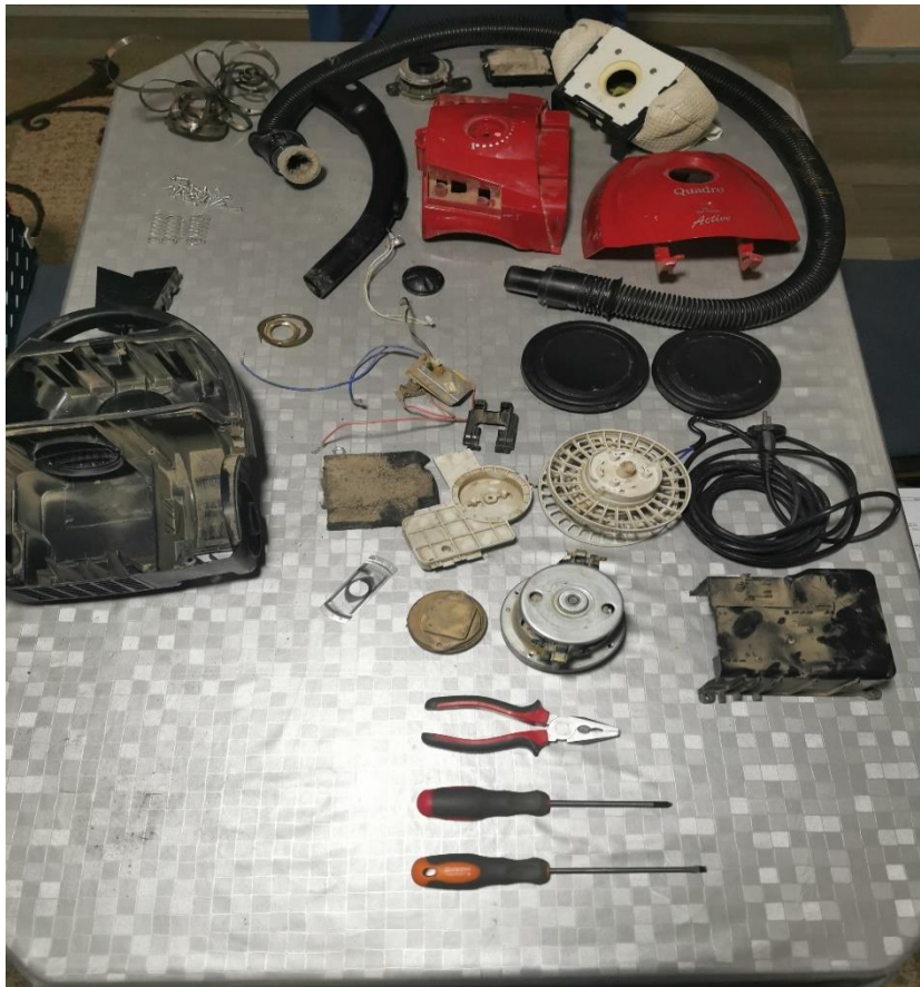
Slika 4.2. Dijelovi usisavača i oprema za rastavljanje usisavača
