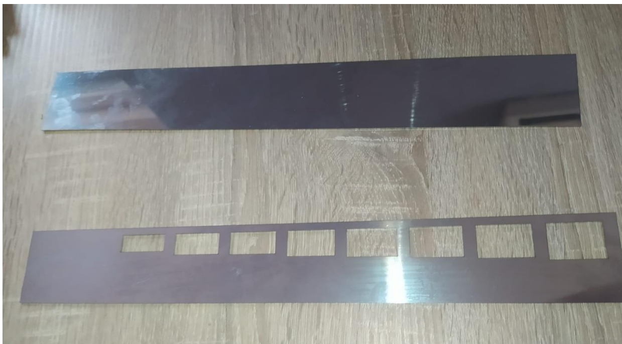
Slika 3.5. Metalne pločice izrezane CNC strojem.
