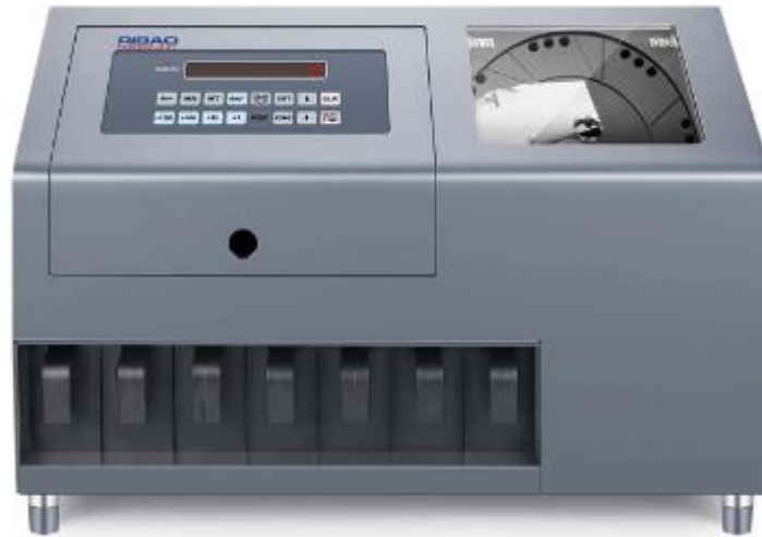
Slika 2.1 Uređaj za sortiranje kovanica s rotirajućim diskom, [4].
