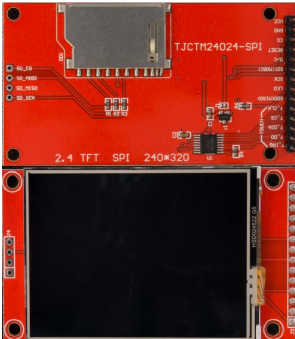
Slika 2.1. Prikaz prednjeg i zadnjeg djela TFT LCD zaslona [1]
