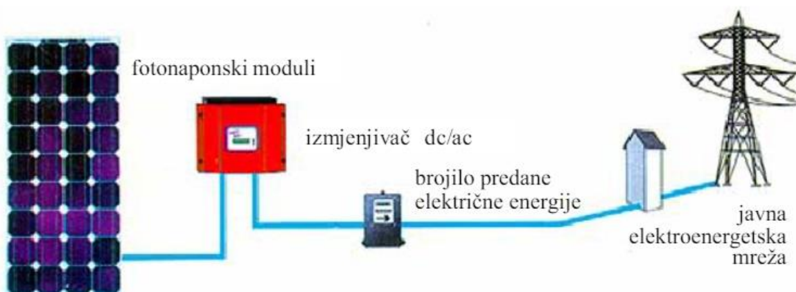
Slika 37. Fotonaponska elektrana direktno povezana na elektroenergetsku mrežu [2]
