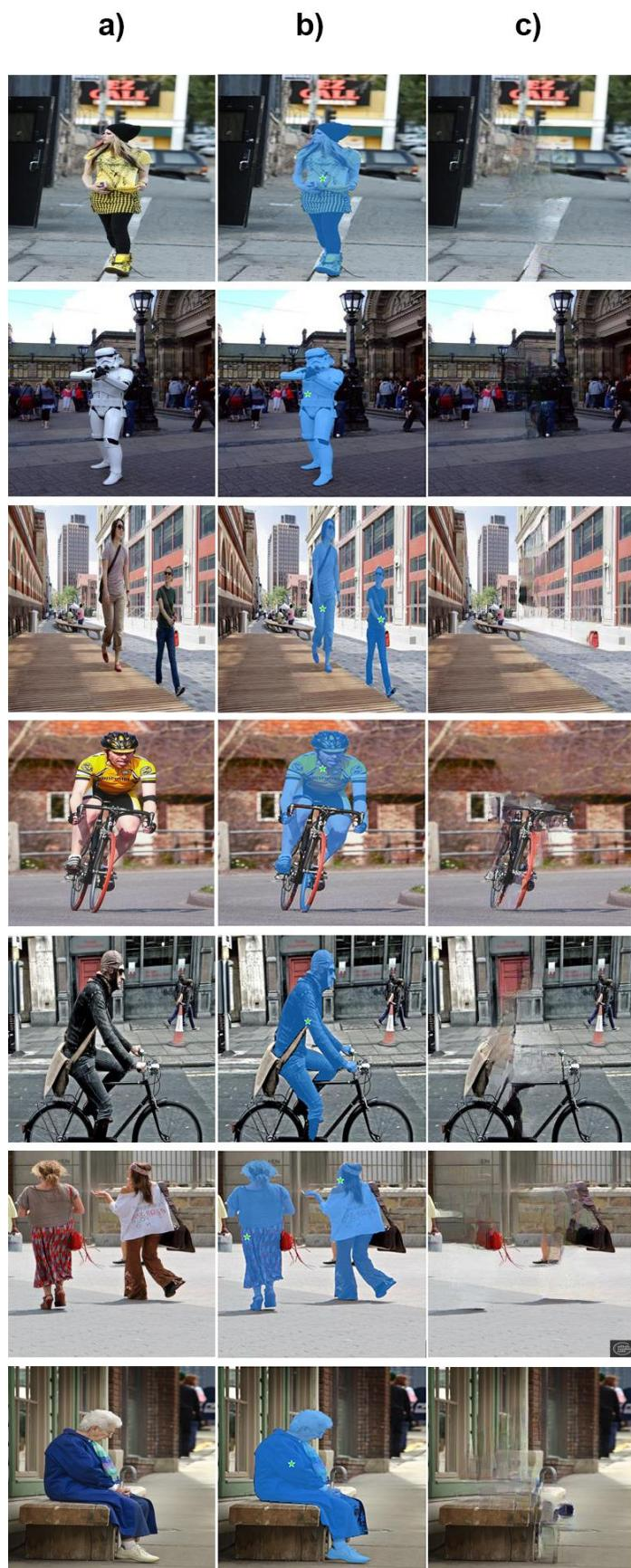
Sl. 5.3. Primjer popunjavanja slika uz korištenje SAM modela. Stupac a) original slika, b) SAM segmentacija, c) konačna slika.
