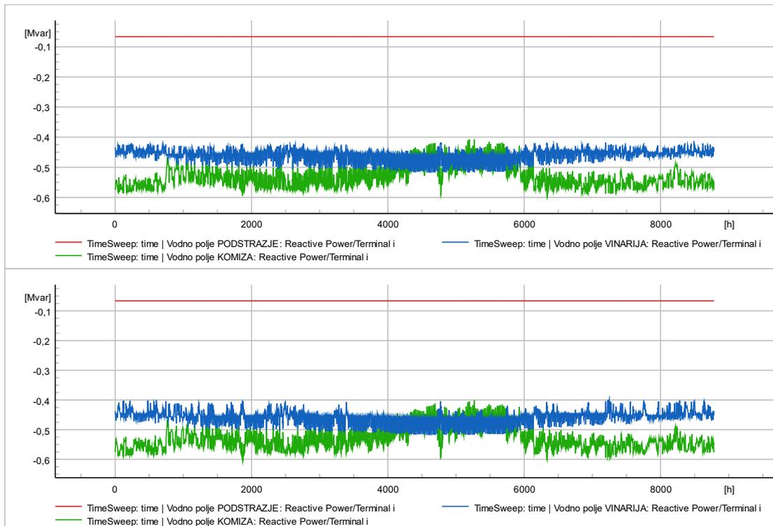
Figure 3.22 Jalovo opterećenje na glavnim dalekovodnim linijama nakon integriranja WPF-a na lokaciji 1
