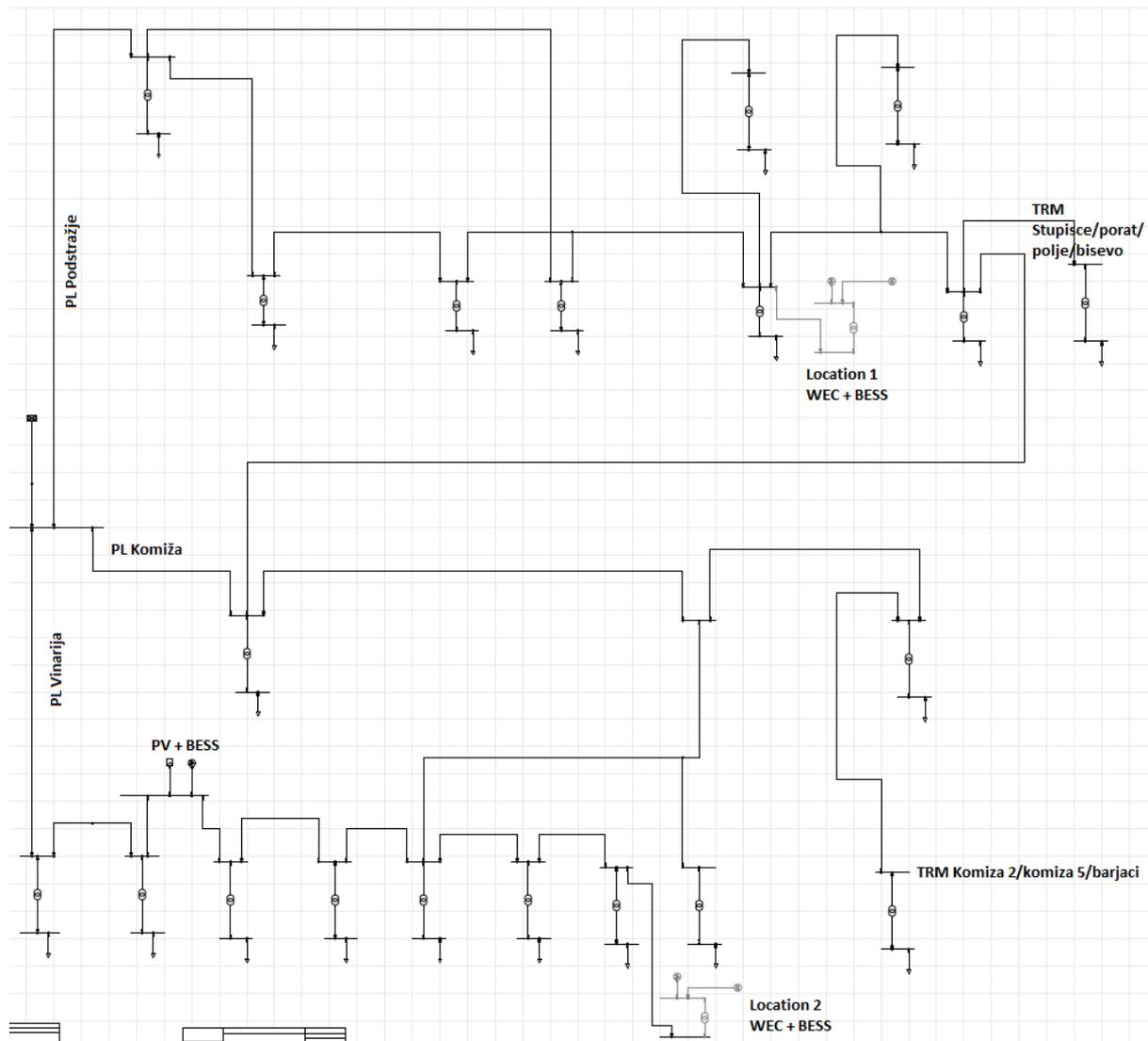
Slika 3.10 Jednopolna shema modela korištena pri simuliranju
