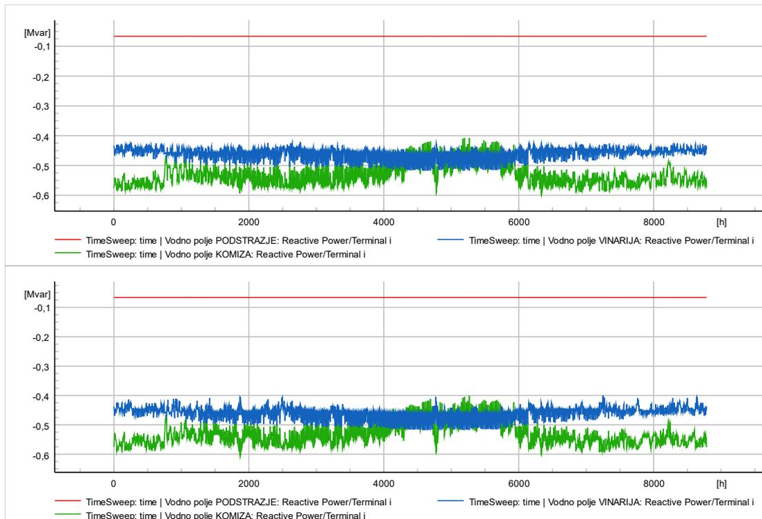
Slika 3.30 Jalovo opterećenje na glavnim dalekovodnim linijama nakon integriranja WPF-a i BESS-a na lokaciji 1
