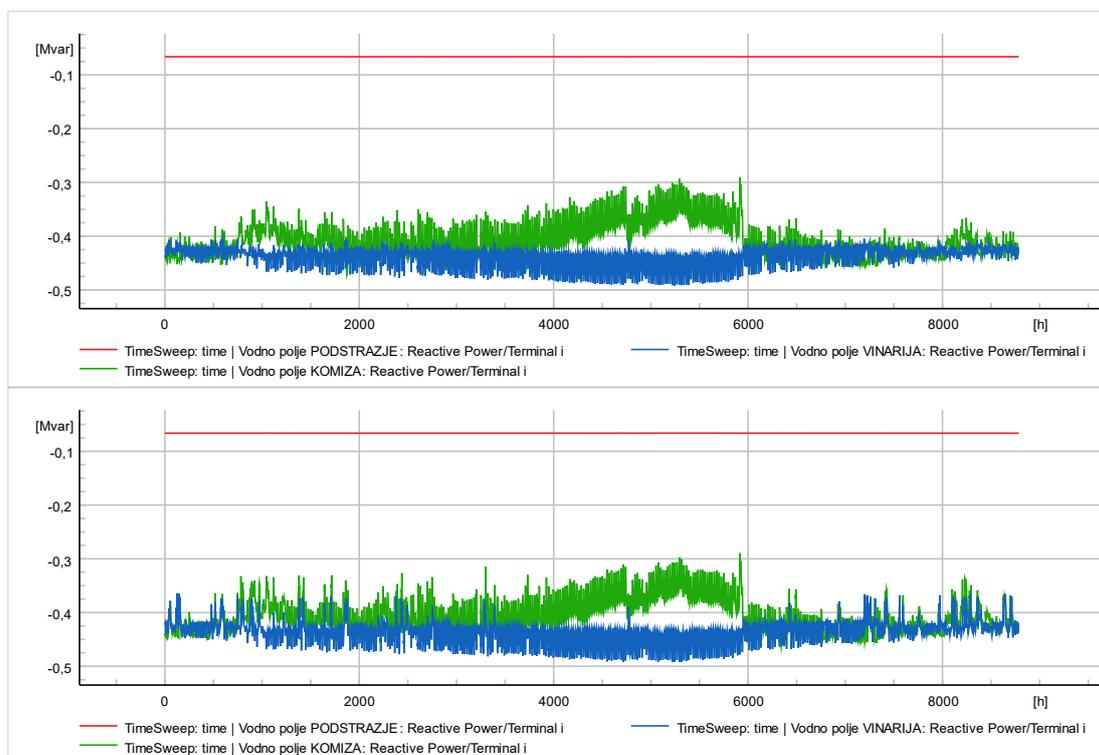
Figure 3.26 Jalovo opterećenje na glavnim dalekovodnim linijama nakon integriranja WPF-a na lokaciji 2
