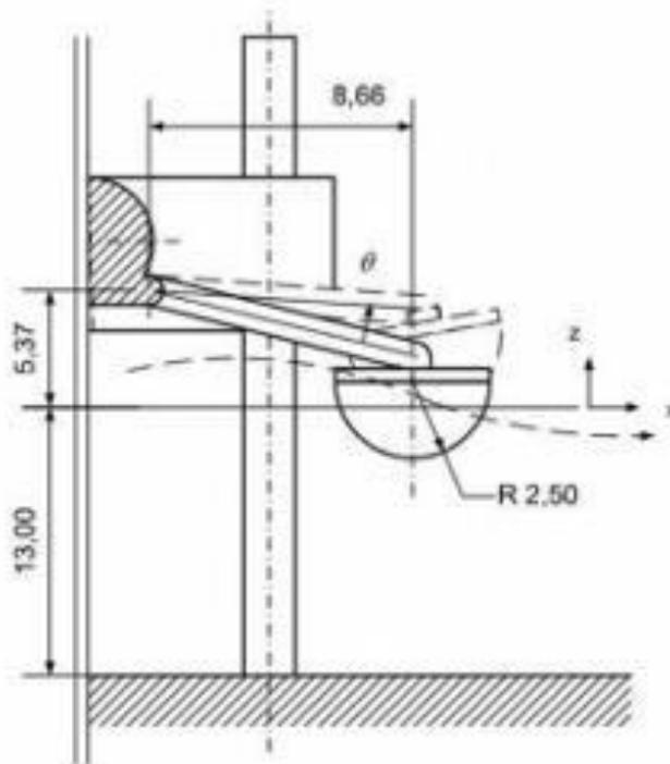
Slika 3.5 Wavestar shema. Reproducirano s dopuštenjem od [19]
