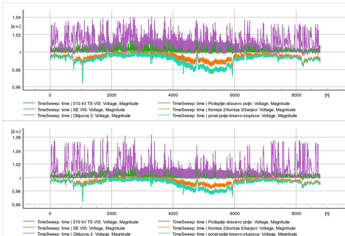
Figure 3.23 Naponske razine na sabirnicama nakon integriranja WPF-a na lokaciji 2
