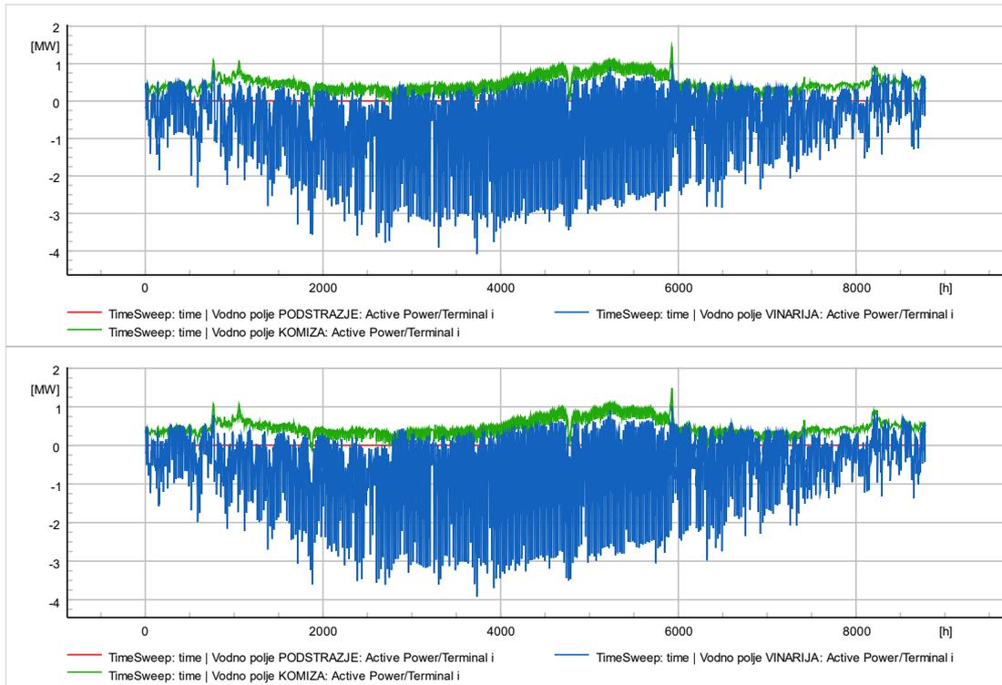
Slika 3.33 Radno opterećenje na glavnim dalekovodnim linijama nakon integriranja WPF-a i BESS-a na lokaciji 2
