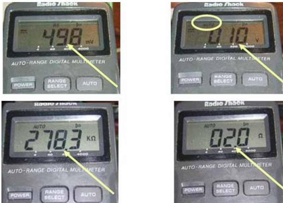
Slika 3.3 Razlučivost digitalnog instrumenta [4]
