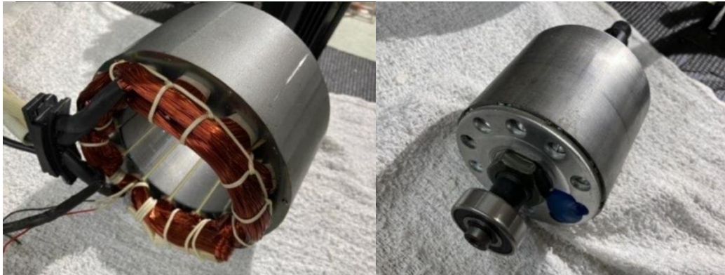
Sl. 6.3 Stator i rotor motora QS138 70H
