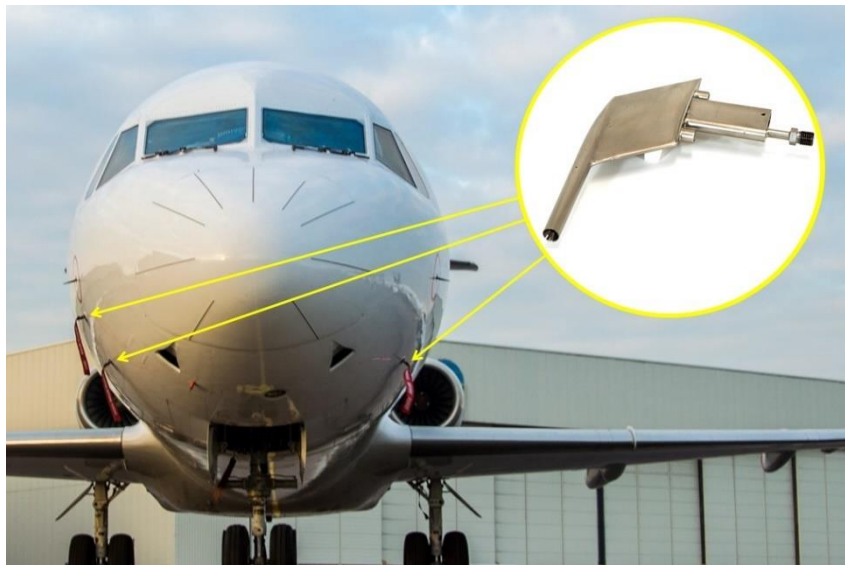
Slika 4.9 primjena pitotove cijevi u zrakoplovstvu za mjerenje strujanje zraka[9]
