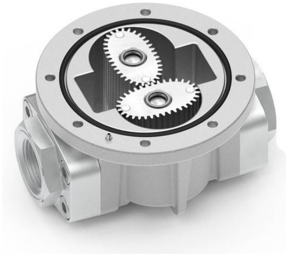
Slika 4.25 unutrašnjost mjerača protoka s ovalnim zupčanicima [25]
