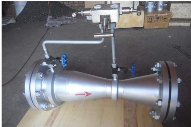
Slika 4.5 venturijeva cijev u praksi[5]
