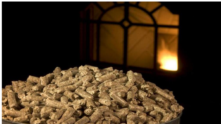
Slika 2.5. Peleti za proizvodnju toplinske i električne energije [5]
