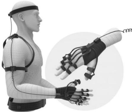
**Slika 2.1.** Oprema za mehanički sustav snimanja pokreta[8].
