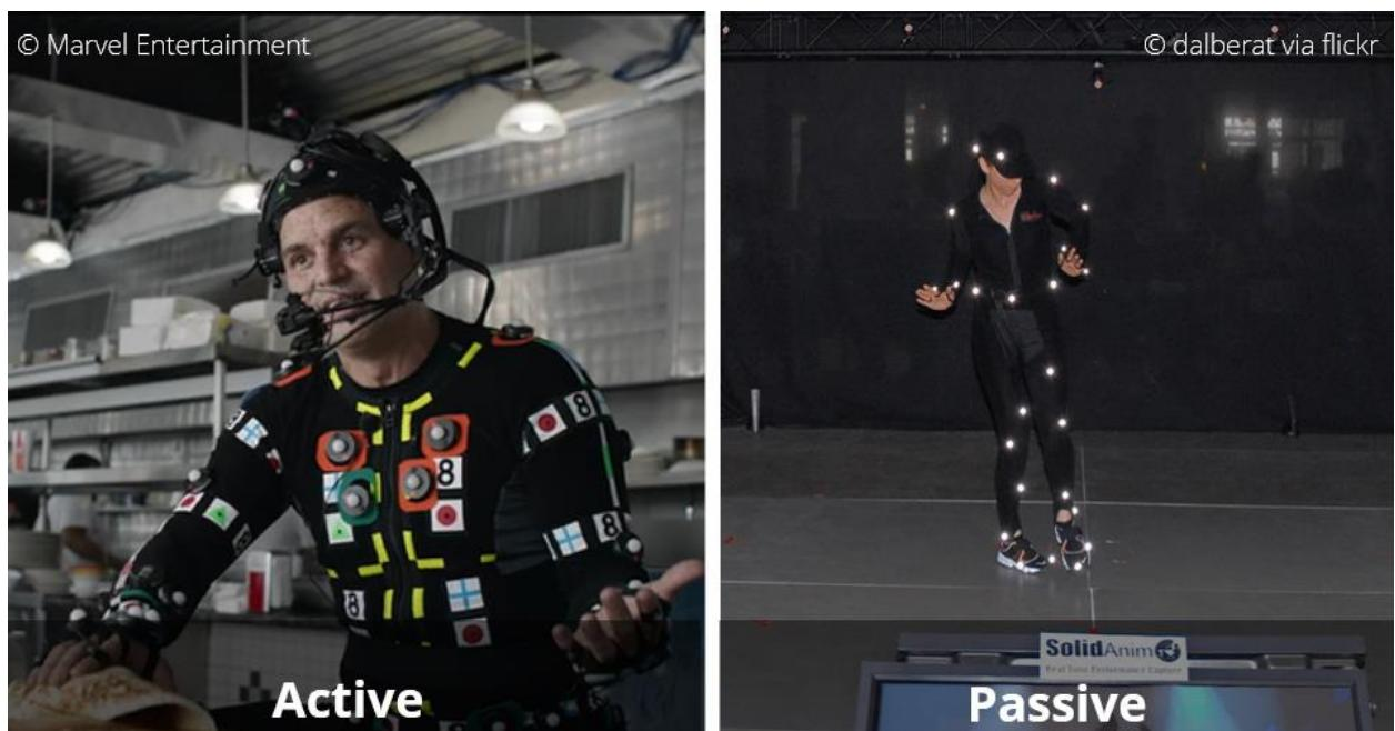
Slika 2.3. Aktivni i pasivni optički sustavi snimanja pokreta[11].
