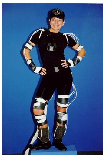
**Slika 2.2.** Oprema za magnetski sustav snimanja pokreta[9].
