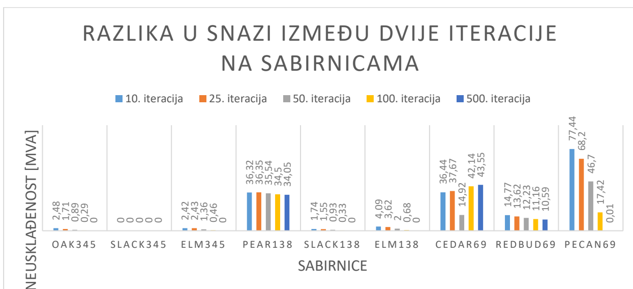
Sl. 4.11. Prikaz razlike u snazi između dvije iteracije na sabirnici nakon konvergiranja.
