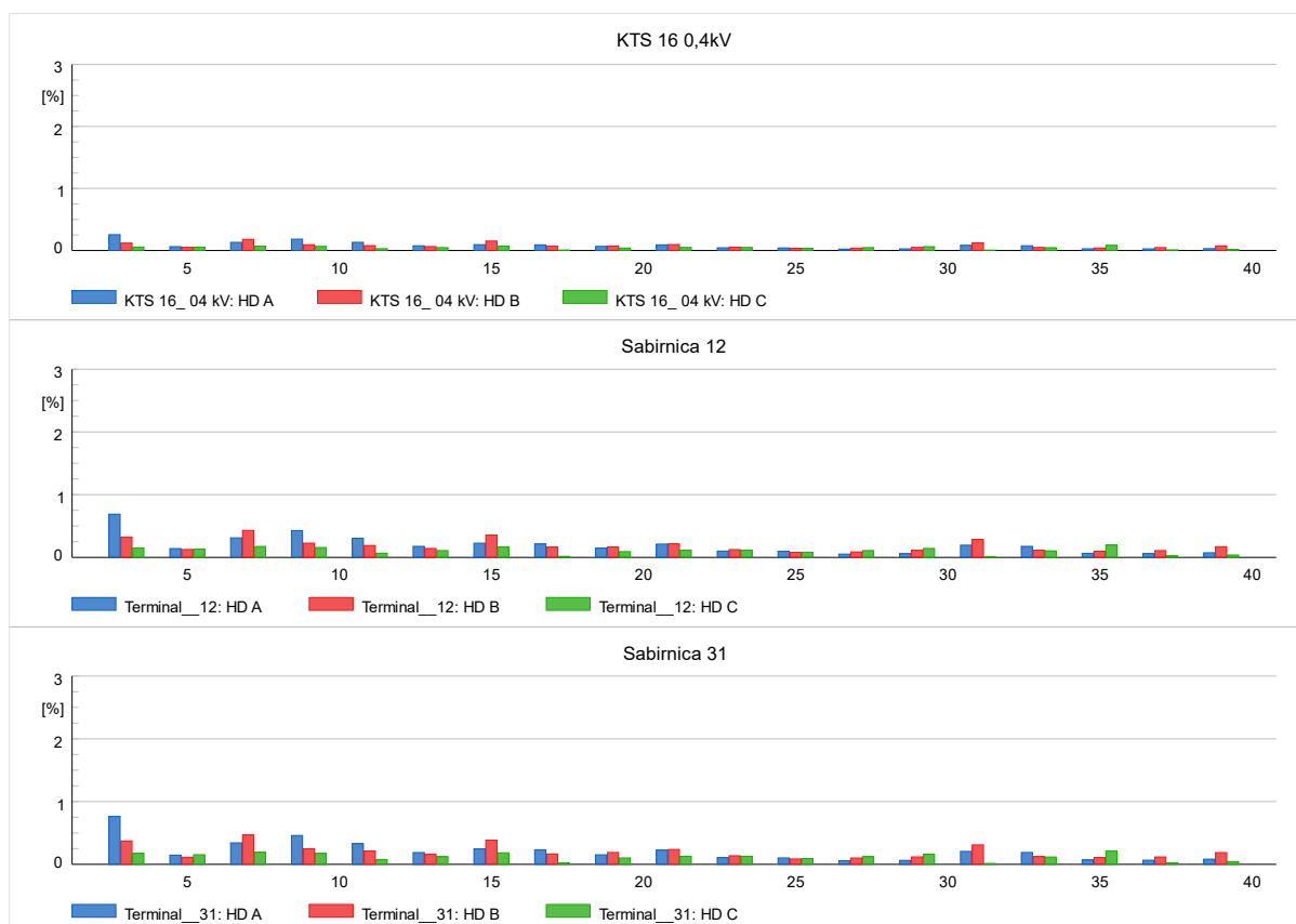
Slika 5.17. Stanje ispitne mreže u 4:00 h na karakterističnim sabirnicama
