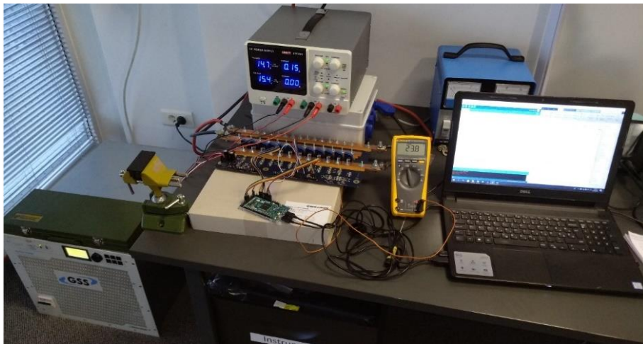
Slika 5.11. Eksperimentalni postav za validaciju metode upravljanja radnom temperaturom tranzistora
