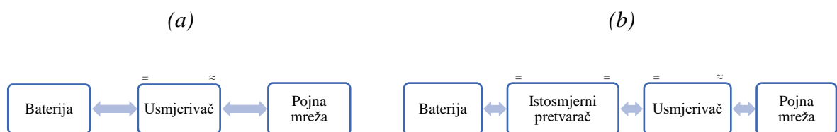
Slika 2.1. Blokovska shema jednostupanjske (a) i dvostupanjske (b) pretvorbe
