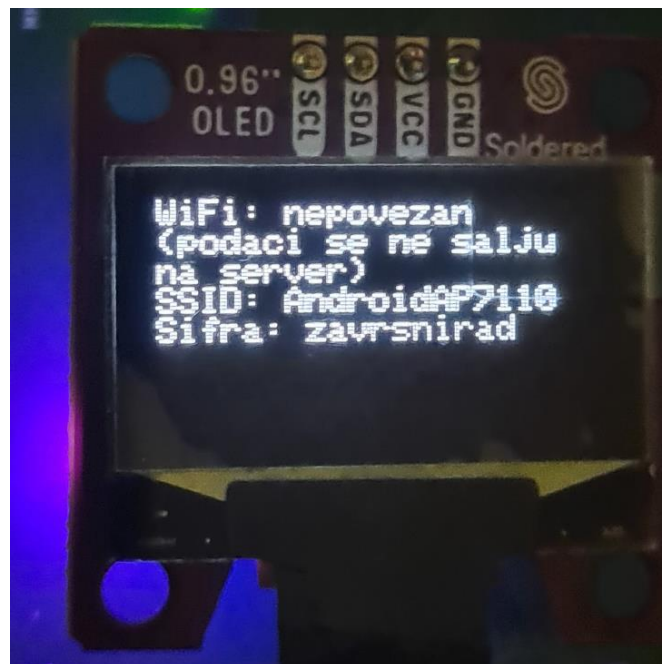
Sl. 3.25. Obavijest o neuspješnom povezivanju na internetsku mrežu i na Arduino oblak
