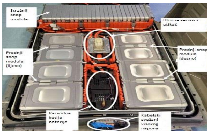
Slika 4.19. Prikaz komponenti baterije [35]
