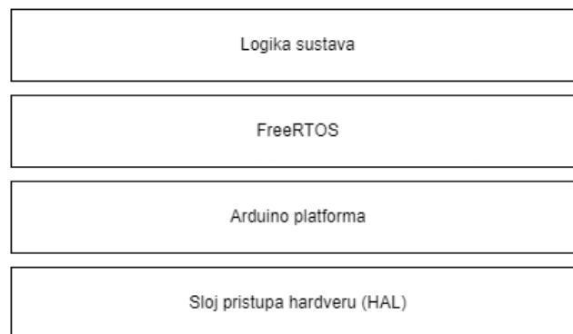
Slika 2.3. Slojevi firmvera sustava
