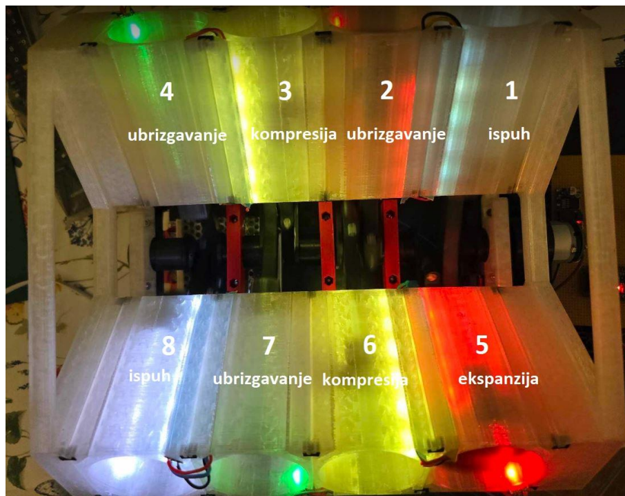
Slika 4.8. Prikaz zajedničkog rada klipova u cilindrima
