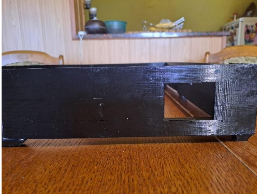
Slika 4.3. Okvir sa prostorom za LCD
