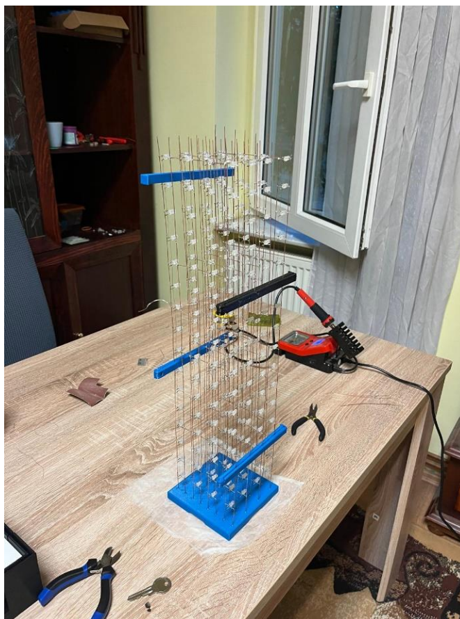
Slika 4.14. Toranj učvršćen kopčama
