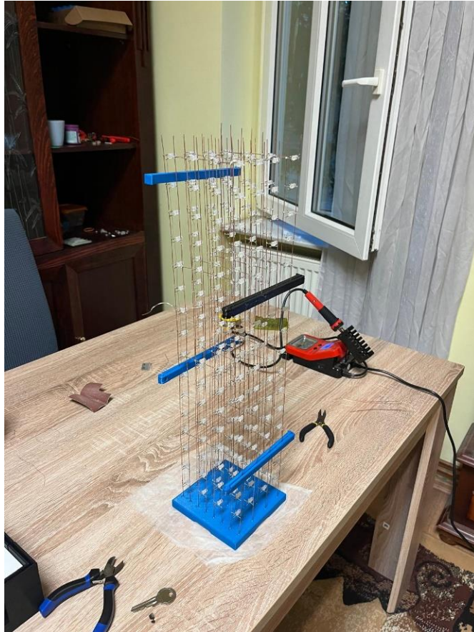
Slika 4.14. Toranj učvršćen kopčama
