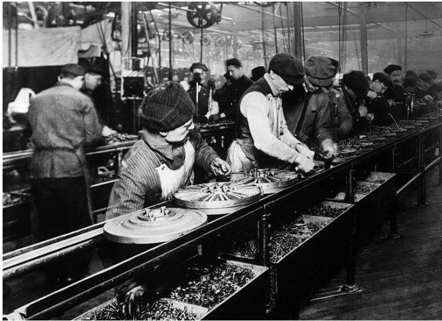
Slika 1.1. Fordova montažna traka godine 1913. [1]
