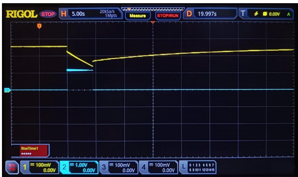
Slika 8.6. Prikaz strujne i naponske karakteristike hibrida baterije i superkondenzatora sa horizontalnom vremenskom bazom 5 s i horizontalnom pozicijom 19.997 s
