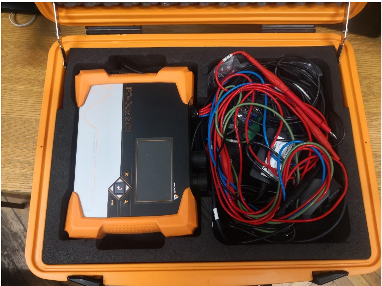
Slika 5.1. Mjerni uređaj PQ-Box 200
