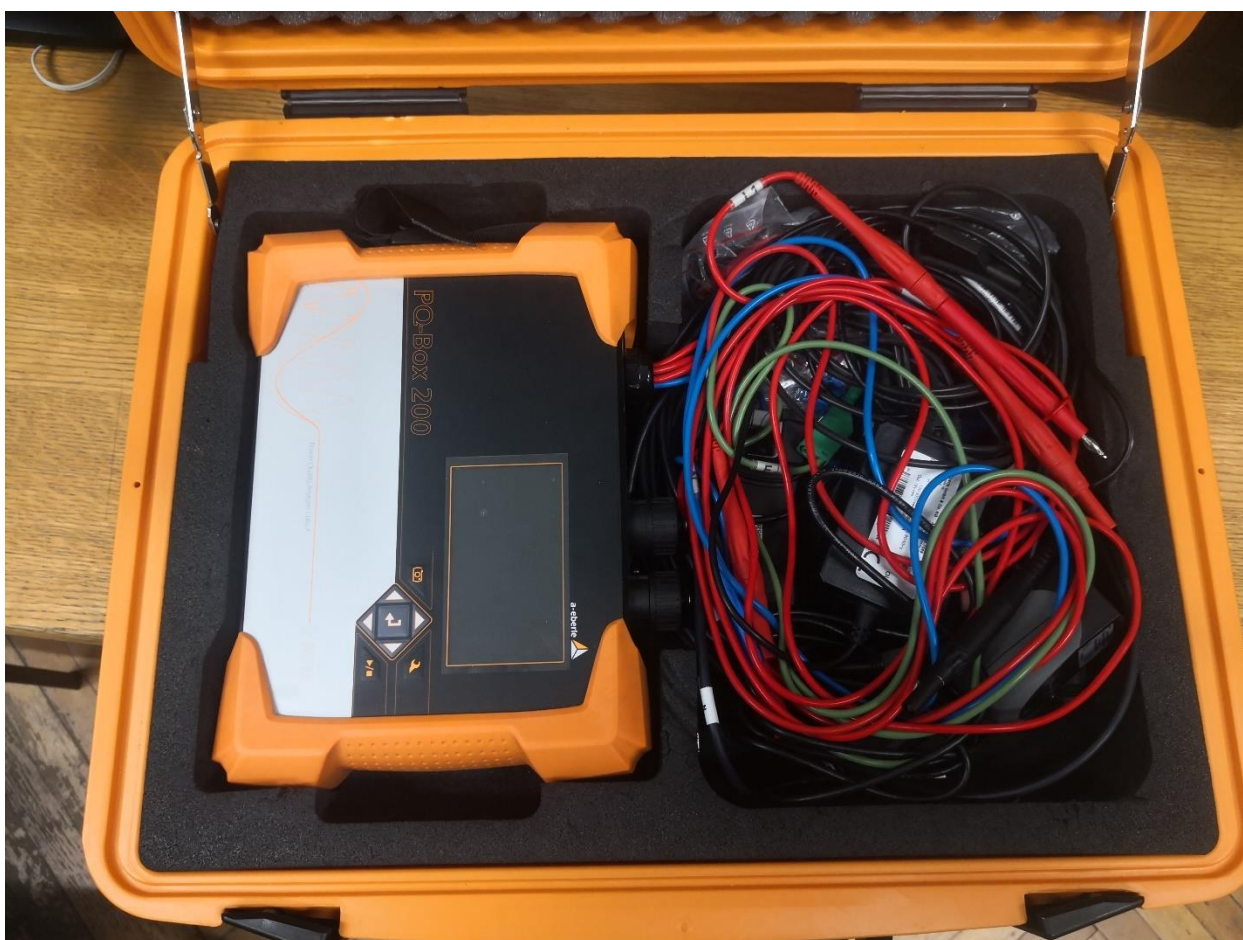
Slika 5.1. Mjerni uređaj PQ-Box 200
