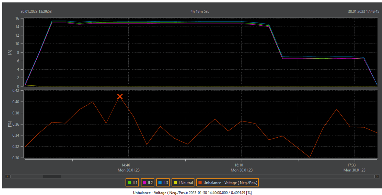
Slika 5.18. Nesimetrija napona pri trofaznom punjenju
