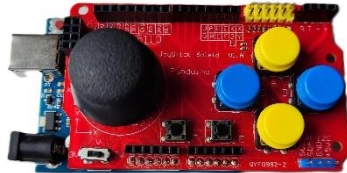
Slika. 3.15. Arduino sa priključenim Joystick Shield-om
