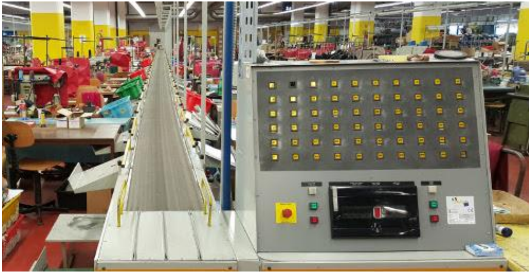
Slika 3.10. Šivaća transportna traka Volonte tip VDN/125/40 [2]
