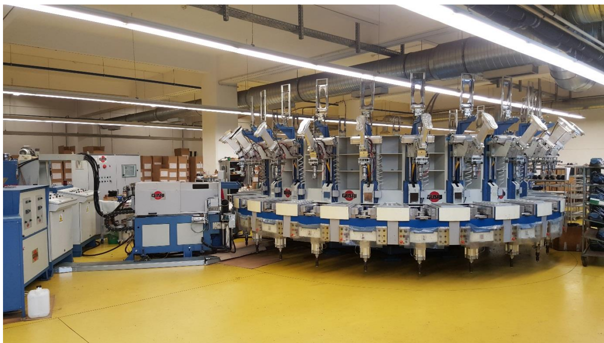
Slika 3.21. Stroj za brizganje đona poliuretanom s 24 stanice DS823/24 proizvođača Gusbi [2]
