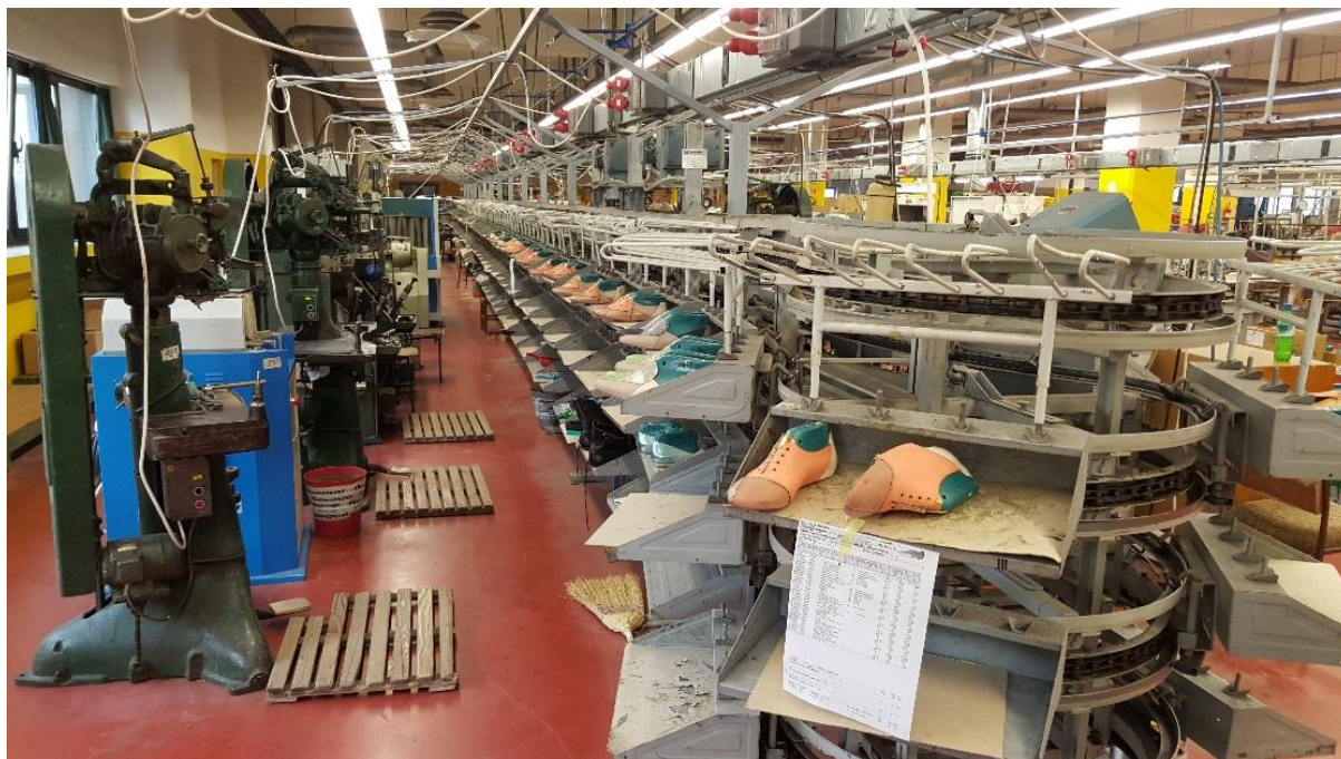
Slika 3.13. Linija za sastavljanje obuće, tzv. konfekcijski krug [2]
