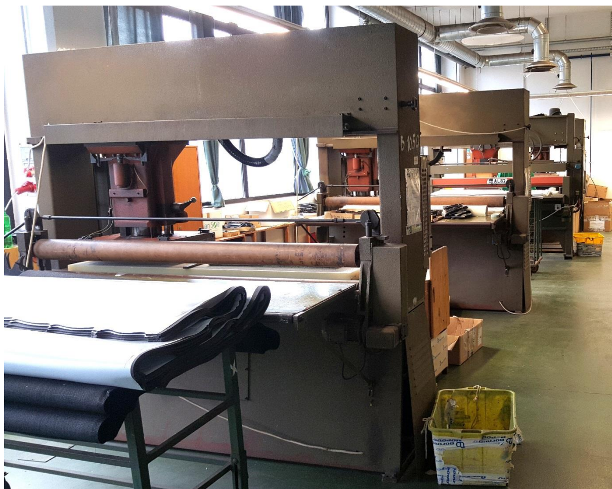
Slika 3.8. Hidraulični mosni sjekački stroj Atom s trofaznim asinkronim motorom [2]
