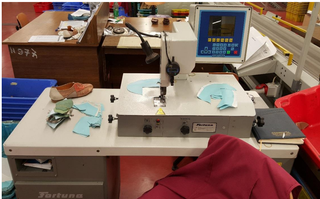
Slika 3.11. Stroj za stanjivanje CS3 Fortuna [2]
