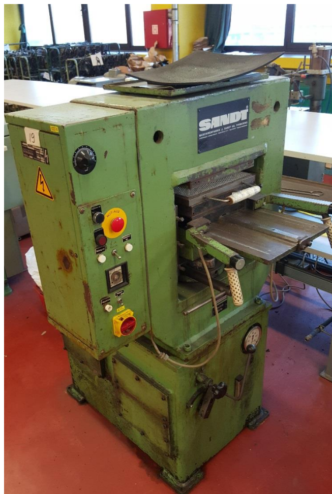
Slika 3.7. Presa Sandt za perforiranje gornjih dijelova obuće [2]
