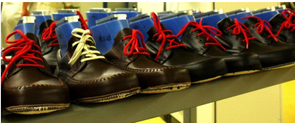
Slika 3.23. Gornjišta obuće čekaju na brizganje PU đona [2]
