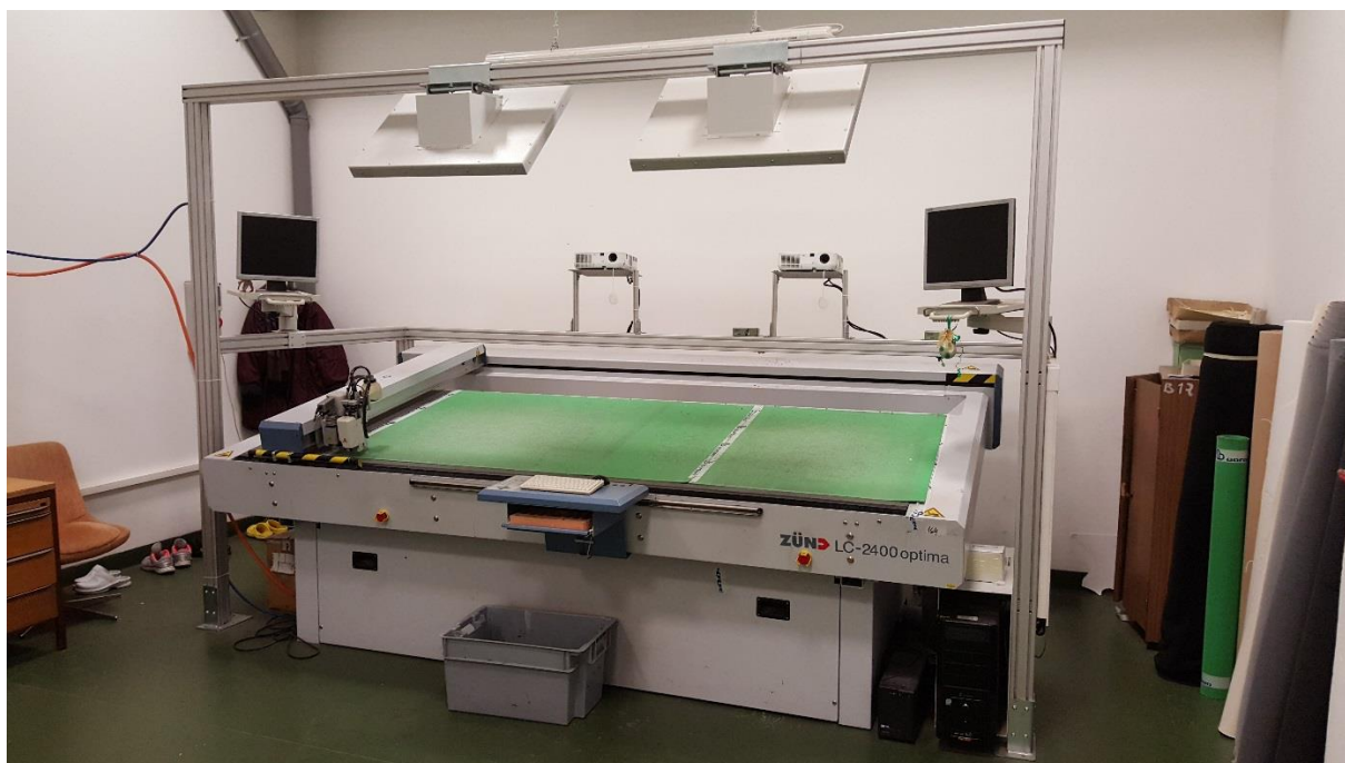
Slika 3.3. CNC rezač LC-2400 optima proizvođača Zund [2]
