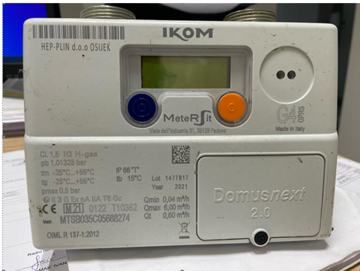
Slika 3.1: Mikrotermalni plinomjer za daljinsko očitavanje, Skladište HEP-Plin
