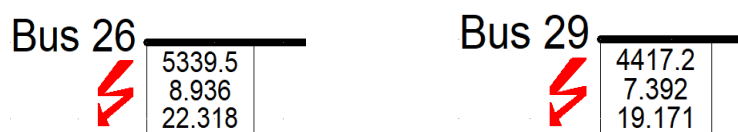
Slika 5.9: Rezultati proračuna kratkog spoja za sabirnice 26 i 29 uz integrirani HVDC sustav
