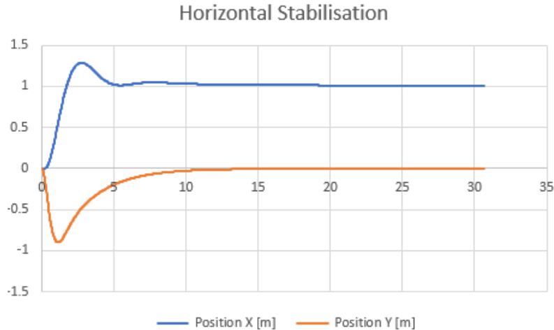
Slika 4.5 Pozicija letjelice u testu horizontalne regulacije
