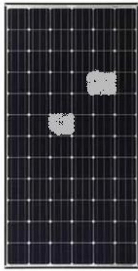
Slika 6.15. Zasjenjenje modula Panasonic VBHN240SE10 uzrokovano ptičjim izmetom
