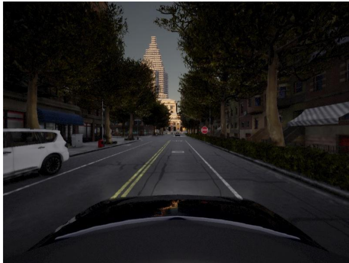
Slika 3.20: Primjer slike RGB kamere unutar CARLA simulatora s vidnim poljem od 105 stupnjeva
