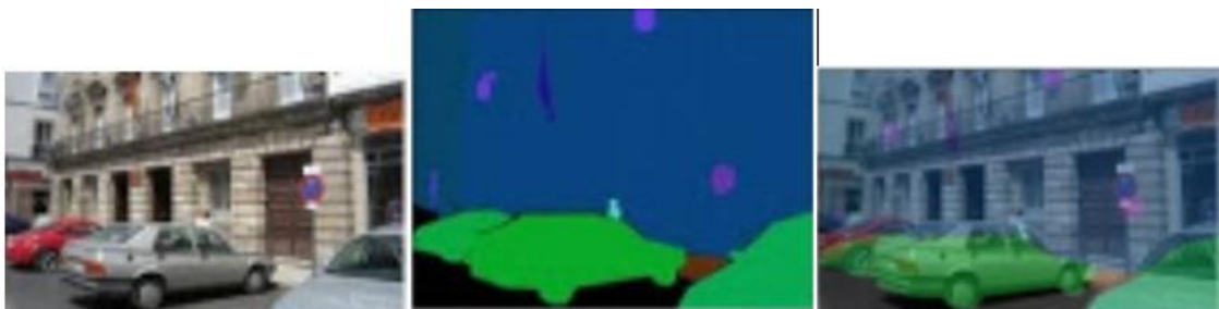
Sl. 2.5. Primjer iz COCO-Stuff skupa podataka. S lijeva na desno: originalna slika, segmentacijska mapa, preklopljena segmentacijska mapa preko originalne slike [19]
