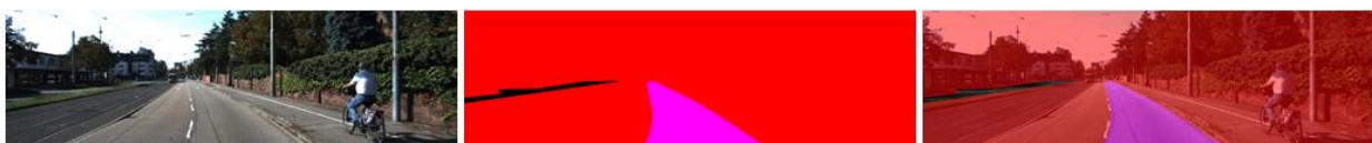
Sl. 2.9. Primjer iz KITTI skupa podataka. S lijeva na desno: originalna slika, segmentacijska mapa, preklopljena segmentacijska mapa preko originalne slike [22]
