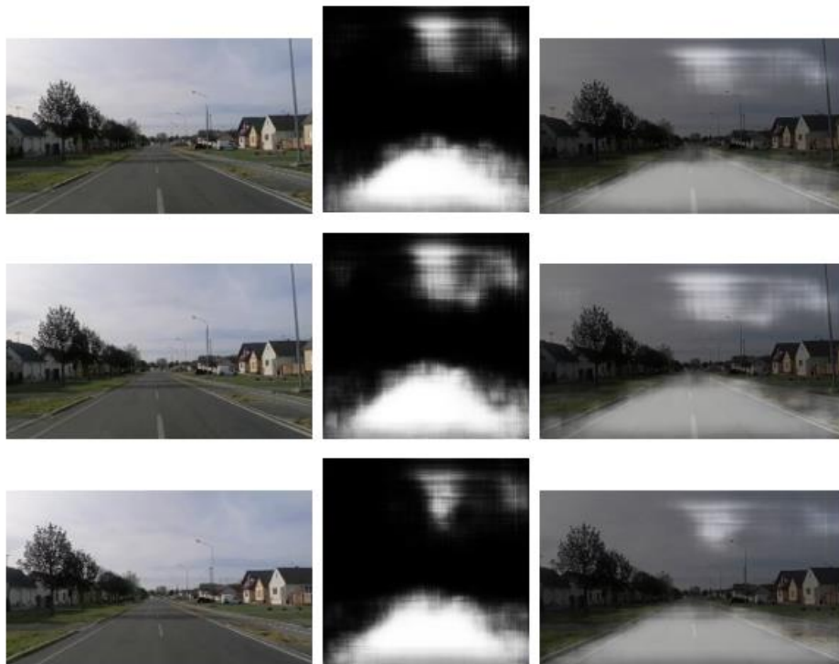
Sl. 4.5. Prikaz rezultata predviđanja modela semantic_model_cs1.tflite . Prvi stupac: ulazna slika, drugi stupac: predviđanje modela, treći stupac: overlay ulazne slike i predviđanja modela.
