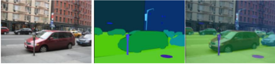
Sl. 2.4. Primjer iz ADE20K skupa podataka. S lijeva na desno: originalna slika, segmentacijska mapa, preklopljena segmentacijska mapa preko originalne slike [15]
