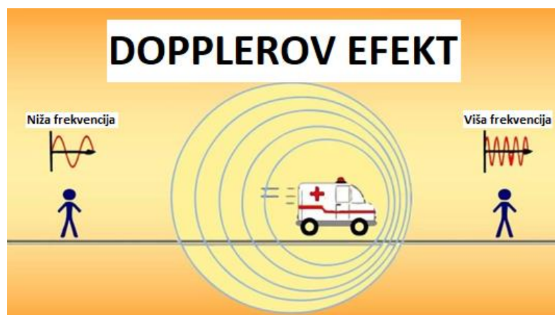
Slika 3.3. Dopplerov efekt u slučaju statične točke promatranja i izvora zvuka koji se giba [15]
