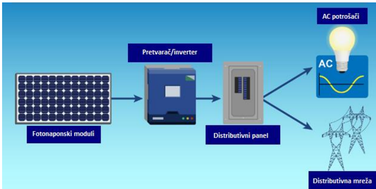
Slika 2.17. Prikaz mrežnog (on-grid) sustava, [9]
