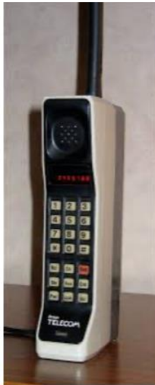
Slika 3.1. Motorola DynaTac, 1G mobilni uređaj [12]
