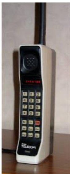
Slika 3.1. Motorola DynaTac, 1G mobilni uređaj [12]
