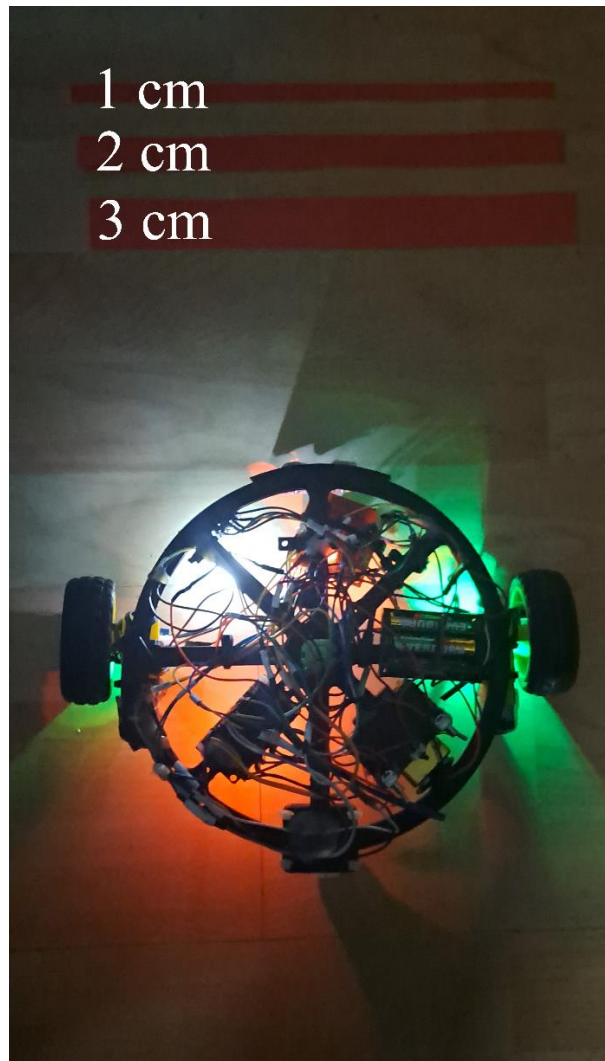
Slika 4.4. Testiranje debljine crte u mračnim uvjetima.
