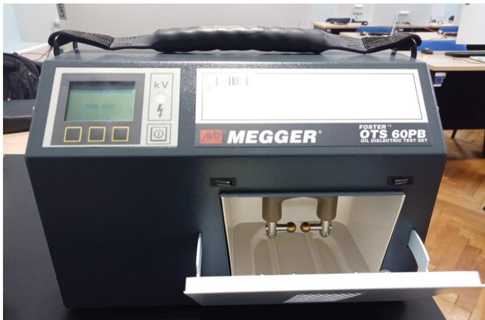
Slika 6.1. Uređaj za mjerenje probojnog napona Megger OTS60PB
