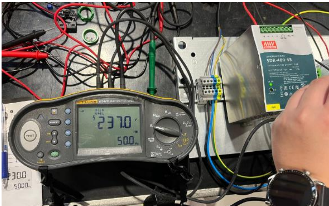
Slika 5.1.7. Mjerenje ulaznog napona s FLUKE 1664 FC višenamjenskim ispitivačem
