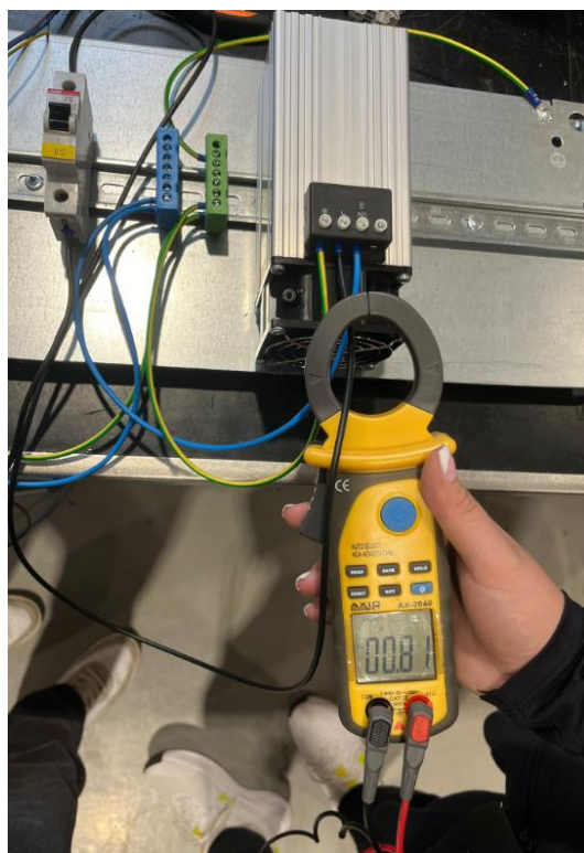
Slika 5.3.6. Mjerenje AC struje s AXIO MET AX-2040 strujnim kještima
