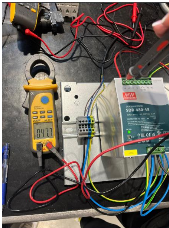
Slika 5.2.5. Mjerenje izlaznog napona s AXIO MET AX-2040 strujnim klještima
