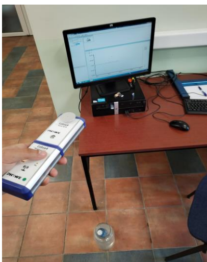
Slika 4.20. Postav eksperimenta potone li tijelo ili pliva sa slanom vodom i bočicom vode
