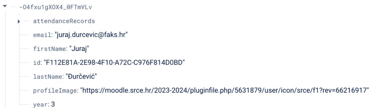
Slika 3.4 Struktura Student objekta na Firebase-u
