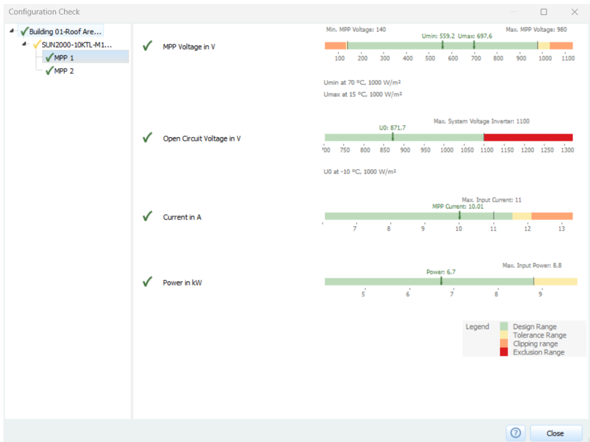
Slika 5.11. Prikaz parametara MPP1 ulaza izmjenjivača
