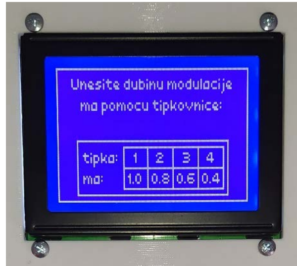
Slika 4.13. Odabir dubine modulacije tokom rada sklopa
