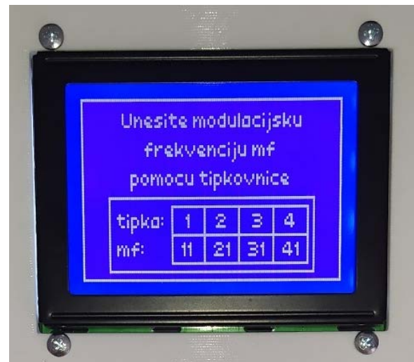
Slika 4.15. Odabir modulacijske frekvencije tokom rada sklopa
