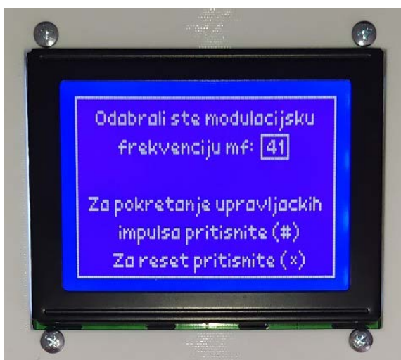
Slika 4.16. Potvrda odabira modulacijske frekvencije tokom rada sklopa
