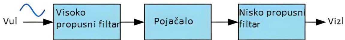
Sl. 2.3. Princip rada pojasno propusnog filtra [8]
