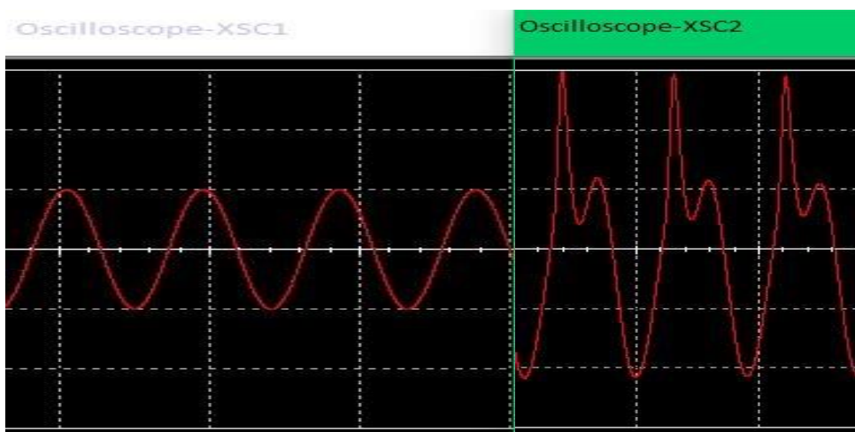
Sl. 3.5. Ulazni signal (lijevo) i izlazni signal (desno), frekvencija 55Hz, A=50 D=25
