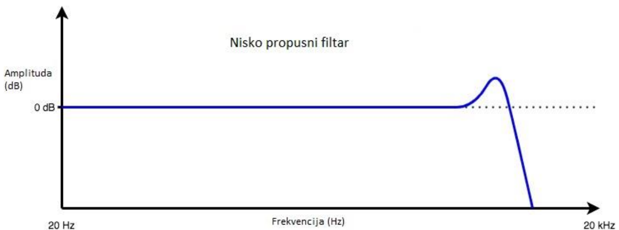
Sl. 2.5. Prikaz nisko propusnog filtra s rezonantnim vrhom [2]
