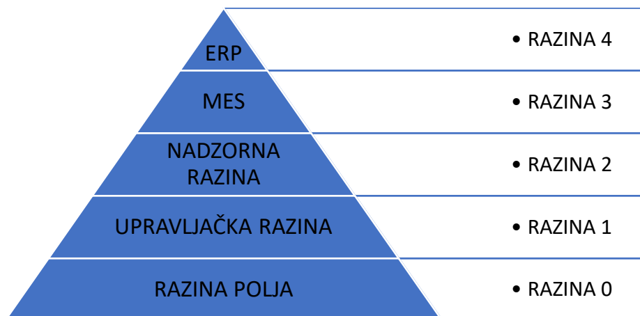
Slika 2.2. Purdue referentni model sustava nadzora i upravljanja
