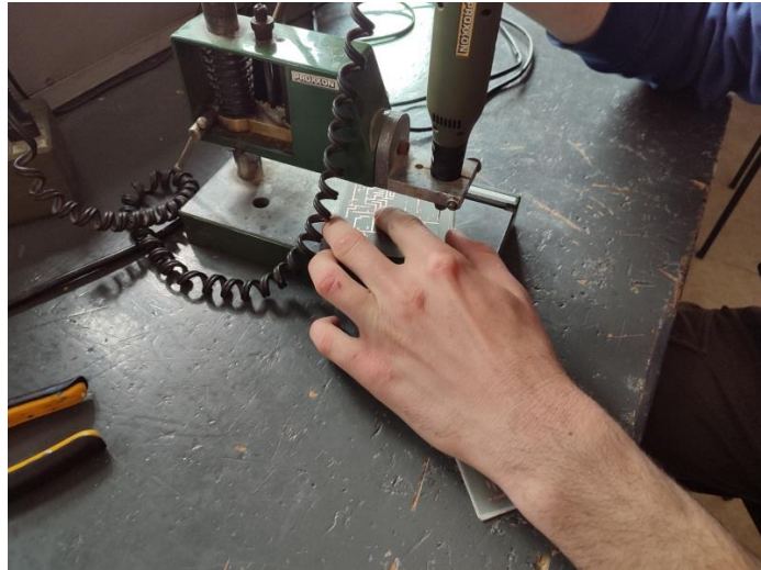
Slika 4.5. Tiskana pločica bez zaštitnog sloja
