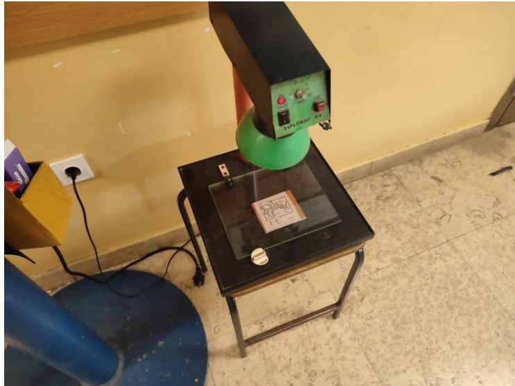
Slika 4.3. Tiskana pločica pod UV lampom
